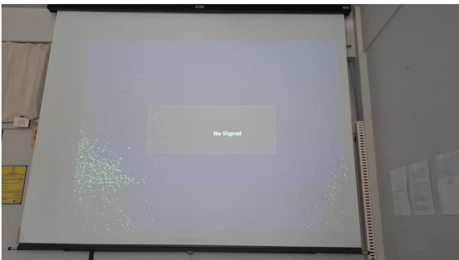
Figura 50 – tela com manchas de fungo
